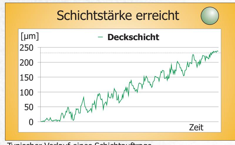
Typischer Verlauf eines Schichtauftrags
